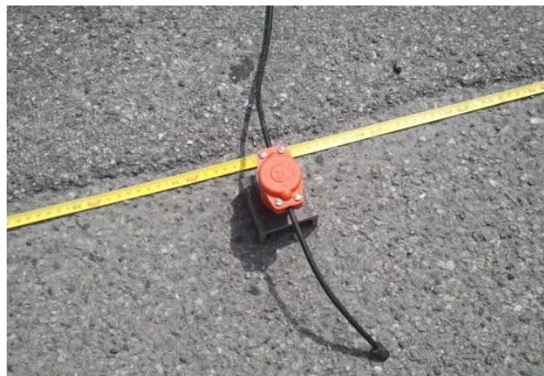
***Geofono verticale da 4.5Hz (Mark) con piastra di supporto.***
