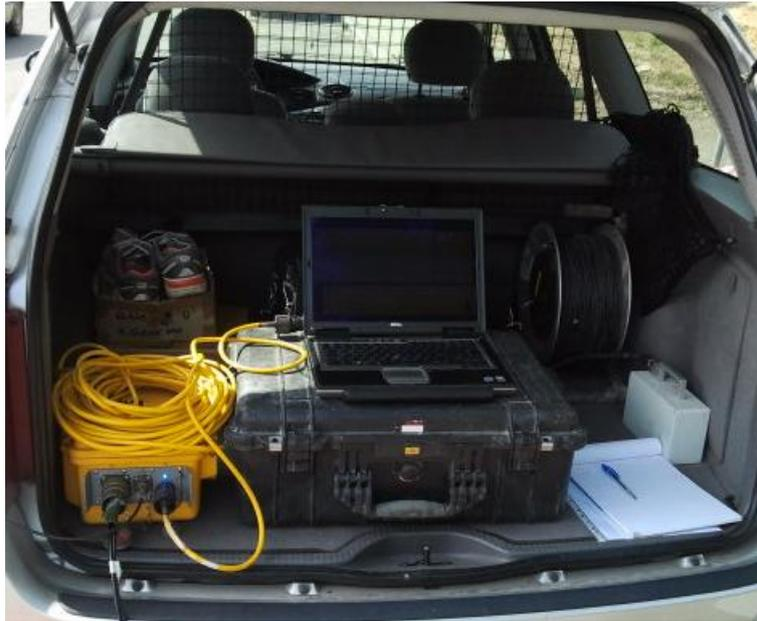
**Apparecchiatura di acquisizione (sismografo Geode).**
